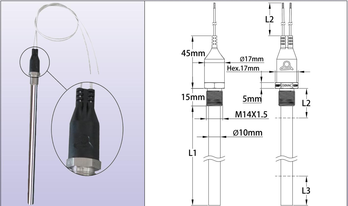
**Principales aplicaciones:** Calentamiento de líquidos cuando el espacio disponible para el componente de calefacción es reducido. Por ejemplo, sistemas de suministro de aceite, filtros de aceite, cárter de motores, cajas de cambios, unidades hidráulicas. El calentador tiene un termostato incorporado. Es el componente de calefacción más pequeño con termostato incorporado.
